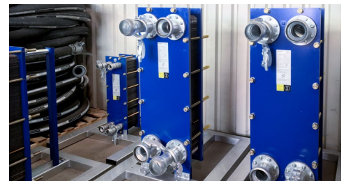
Plattenwärmetauscher zur Systemtrennung
