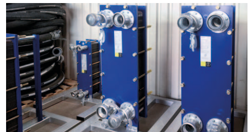
Plattenwärmetauscher zur Systemtrennung
