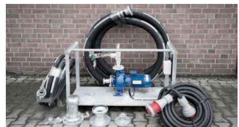
Pumpen, Schläuche, Flansche, Leistungskabel
