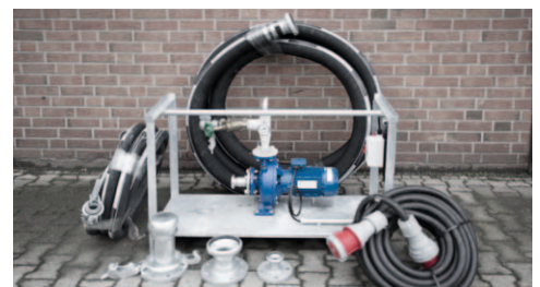
Pumpen, Schläuche, Flansche, Leistungskabel
