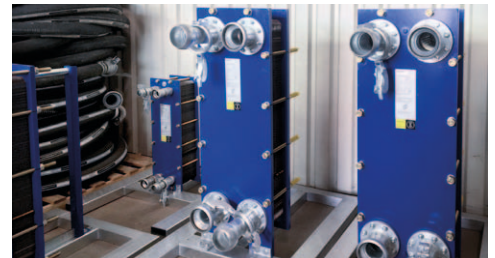
Plattenwärmetauscher zur Systemtrennung
