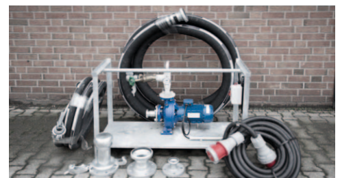
Pumpen, Schläuche, Flansche, Leistungskabel
