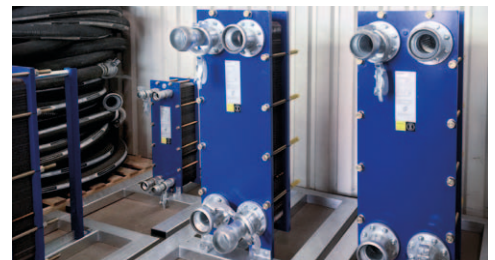
Plattenwärmetauscher zur Systemtrennung
