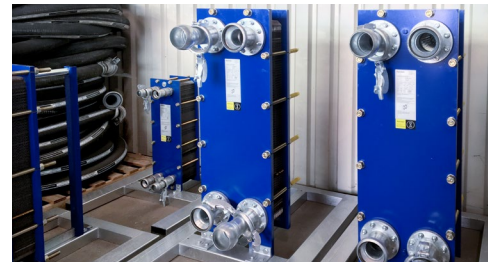
Plattenwärmetauscher zur Systemtrennung
