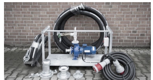
Pumpen, Schläuche, Flansche, Leistungskabel
