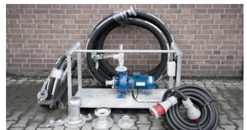
Pumpen, Schläuche, Flansche, Leistungskabel
