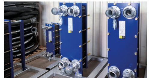
Plattenwärmetauscher zur Systemtrennung
