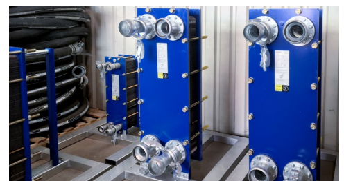
Plattenwärmetauscher zur Systemtrennung
