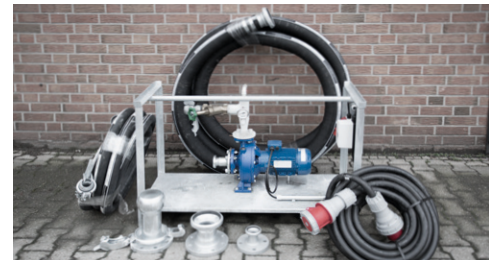
Pumpen, Schläuche, Flansche, Leistungskabel
