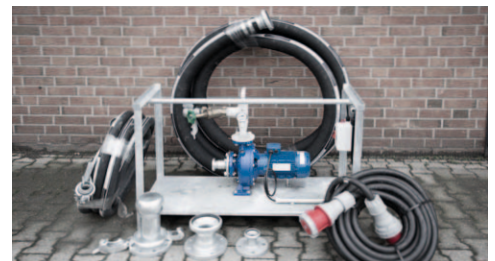
Pumpen, Schläuche, Flansche, Leistungskabel
